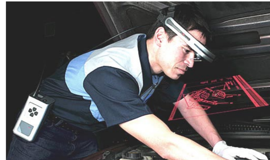
Abbildung 9: Kommerzielle Anwendung eines Virtual Retinal Displays mit monochromer Darstellung, Microvision NOMAD [15]
