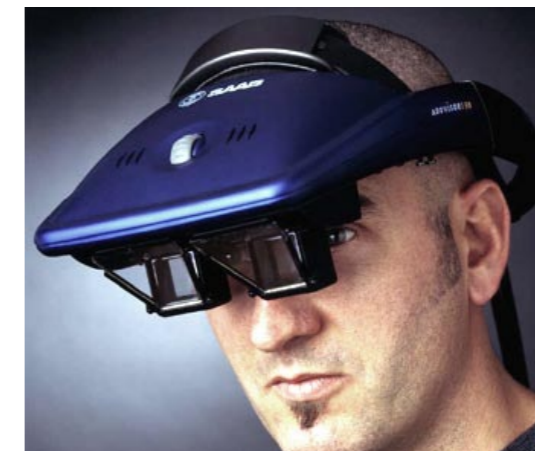
Abbildung 8 : Head-Mounted Display (HMD) mit OST-Technologie der Firma SAAB [11]
