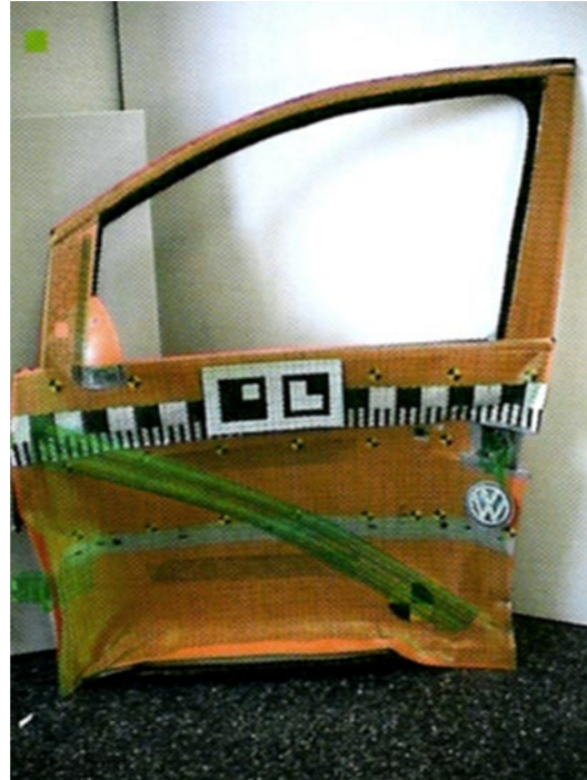
Abbildung 15: Akvika-Projekt, Augmentierung gecrashter Fahrzeugtüren mit der Darstellung der zuvor berechneten Simulationsdaten [25]
