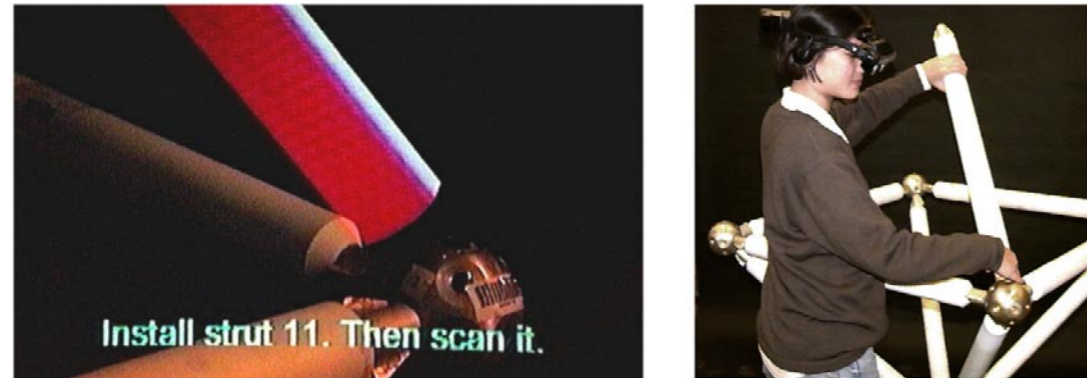
Abbildung 17: ARC-Projekt, Visualisierung einer Bauanleitung mittels Augmented Reality [26]
